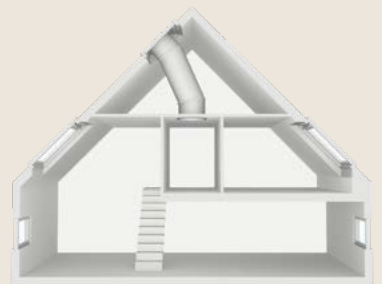
Merev csöves fénycsatorna magastetőbe
