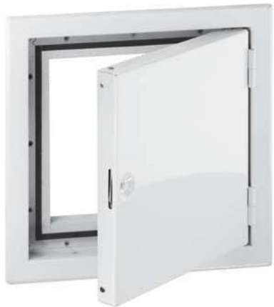
Fire-Star SW Solid mit Brandschutz I30/ EI30/ I90 und EI90 für Gipskartonschachtwände und I90 für Massivwände
