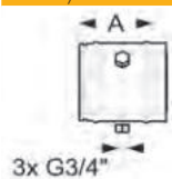
Mérőnyílásos elem a szilárd részecskék méréséhez
