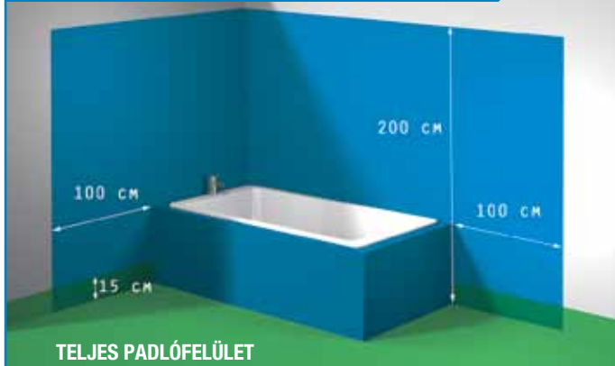
Vízszigetelés zuhany beépítése esetén
