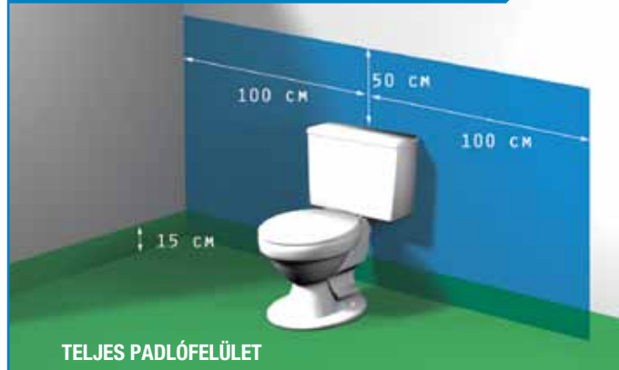
Vízszigetelés WC / bidé beépítése esetén
