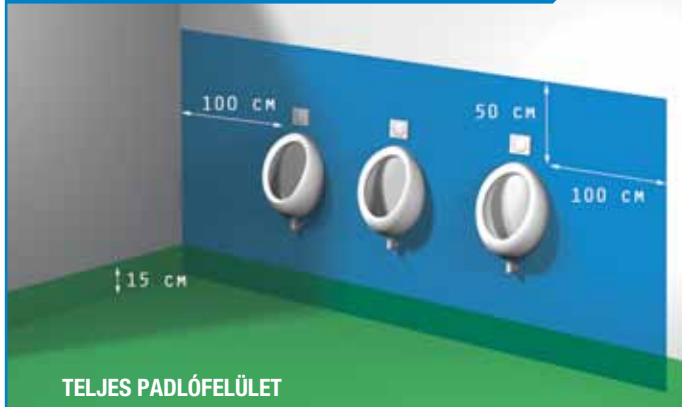
Vízszigetelés pissoire beépítése esetén
