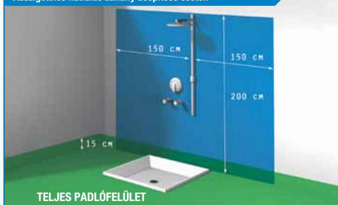
Vízszigetelés hátfalas zuhany beépítése esetén
