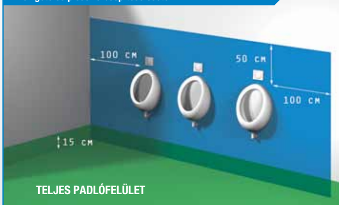
Vízszigetelés pissoire beépítése esetén
