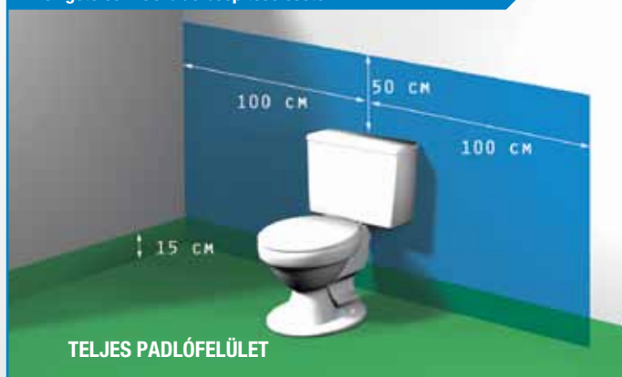
Vízszigetelés WC / bidé beépítése esetén
