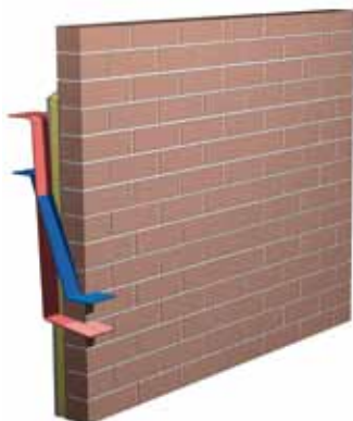
Aislamiento en la cara interior. Punto de rocío en la cara interna.
