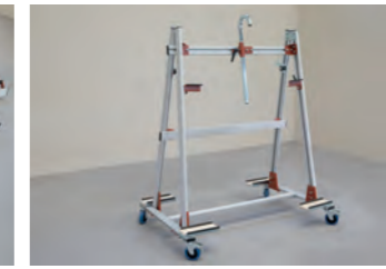
CARRELLO DI MOVIMENTAZIONE predisposto per eseguire la stesura della colla sul retro lastra.
