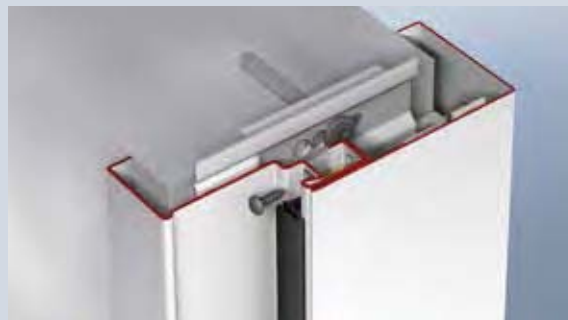
Csavarozza a 2. ellentokprofilat a tömítési hornyon keresztül az 1. tokprofilhoz, majd takarja el azt az ajtó tömítéssel
