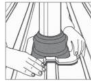
4. A Dektite-et pontosan formálja rá a profillemmeze.
