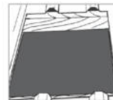
4. A 30 mm-es vonalon belül vágja ki a tetőt. Sorjázza le az éles széleket. A tetőkivágás stabilizálásához, ahol szükséges, szereljük fel a kiváló gerendákat.
