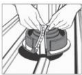
2. A Dektite-et fedtesse a csőre és a fémszárat illessze össze (fentről lefelé).
