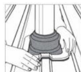
4. A Dektite-t pontosan formálja rá a profilmezére.
