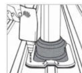
5. Rögzítse a Dektite-t önfúró csavarokkal vagy Bulb-lite szegeccsel
