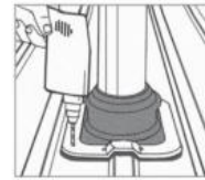
5. Rögzítse a Dektite-et önfúró csavarral vagy Bulb-tite szegeccsel
