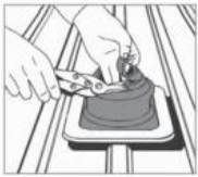
1. Illessze a Dektite-et a csőhöz.
